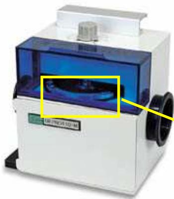
拡散反射法：粉体に赤外光を照射すると、粉体表面での正反射光と粉体内部からの拡散反射光が得られる。このうちの拡散反射光を用いてスペクトルを解析する方法。前処理が簡単であり、表面吸着物質に対する知見が多く得られる
